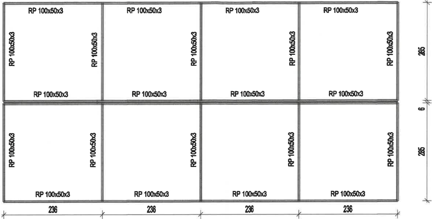
Rzut elementów konstrukcyjnych podłogi
